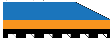
MF řemen s gumovým ozubením pro synchronní pohyb.
